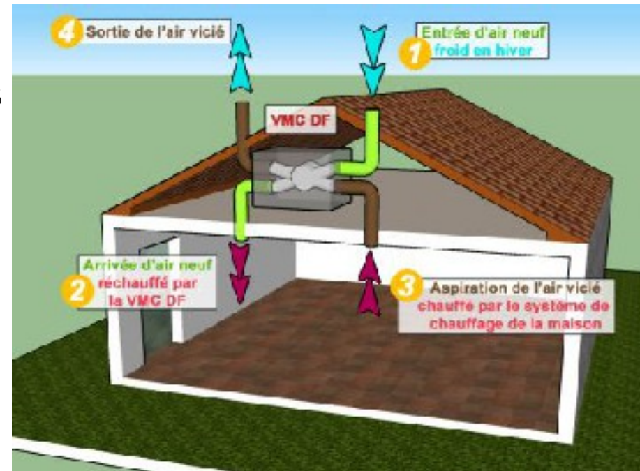
Fonctionnement VMC double flux (DF).
